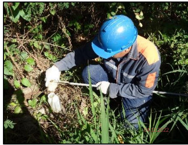
ในท่อระบายน้ำก่อนระบายออกจากพื้นที่โครงการ รูปที่ 3-8 แสดงการเก็บตัวอย่างน้ำทิ้ง เดือนธันวาคม 2565
