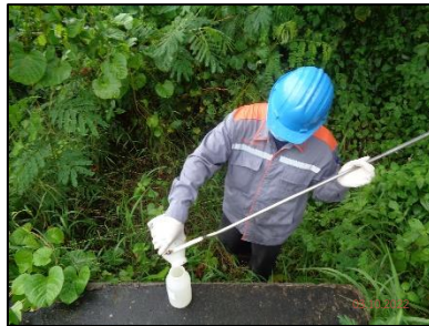
ในท่อระบายน้ำก่อนระบายออกจากพื้นที่โครงการ รูปที่ 3-6 แสดงการเก็บตัวอย่างน้ำทิ้ง เดือนตุลาคม 2565
