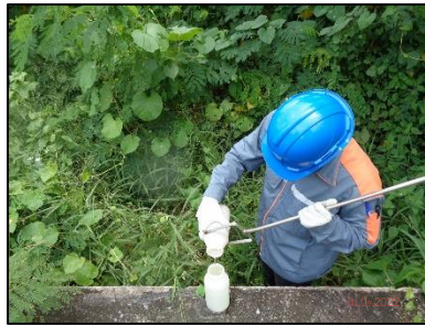
ในท่อระบายน้ำก่อนระบายออกจากพื้นที่โครงการ รูปที่ 3-5 แสดงการเก็บตัวอย่างน้ำทิ้ง เดือนกันยายน 2565
