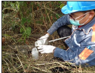
ในท่อระบายน้ำก่อนระบายออกจากพื้นที่โครงการ รูปที่ 3-7 แสดงการเก็บตัวอย่างน้ำทิ้ง เดือนพฤศจิกายน 2565
